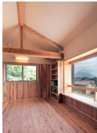
2階は子ども部屋のみ。桜島が見える大きめの窓に、出窓を利用したベンチを設置。冬の日射取得を考慮した形状
