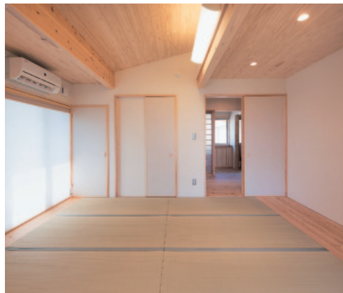
和室は寝室を兼ねているのでシンプルに。写真左に見えるのが、断熱性の高いハニカムサーモスクリーン。窓辺の熱の出入りを防ぐため、外気の影響を受けにくい
